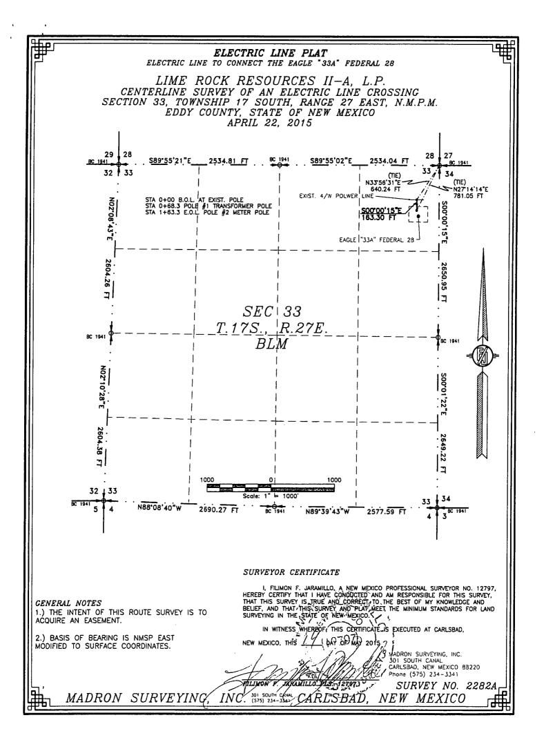
ELECTRIC LINE PLAT ELECTRIC LINE TO CONNECT THE EAGLE "33A" FEDERAL 28
