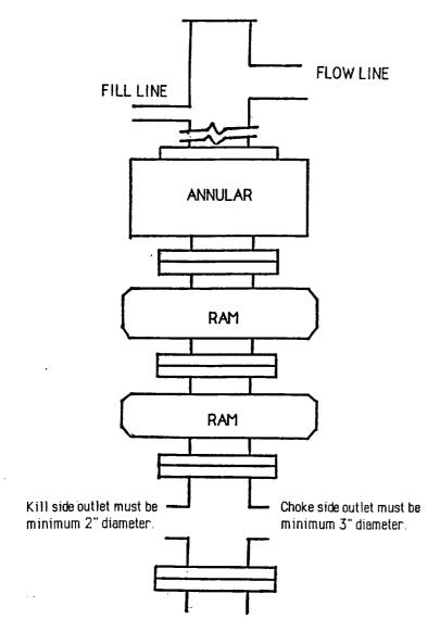
TYPICAL BOP STACK & CHOKE MANIFOLD
