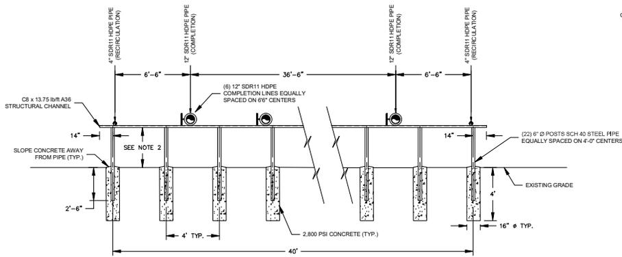
DETAIL 2 - PIPE FRONT ELEVATION COMPLETION
