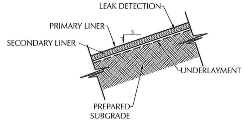
**LINER SYSTEM SIDE SLOPE DETAIL** (10)
