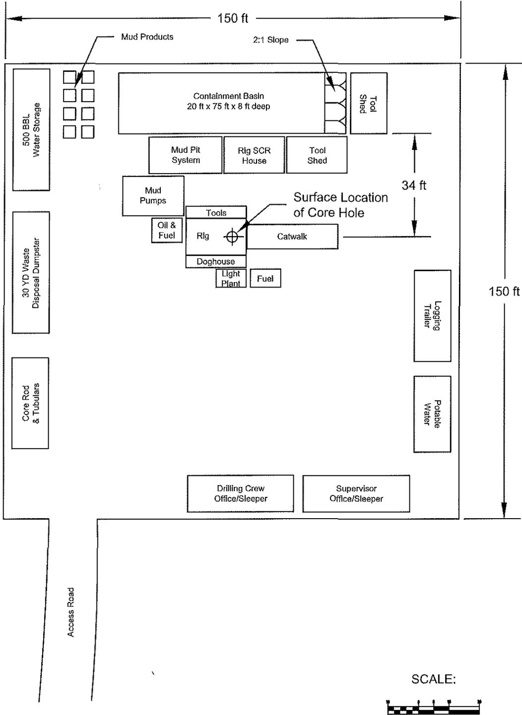
TYPICAL CORE RIG DRILL PAD LAYOUT
