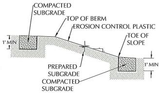
**EROSION CONTROL PLASTIC** ANCHOR TRENCH DETAIL NOT TO SCALE
