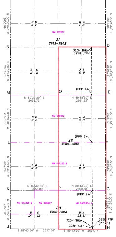
A=N: 376840.37 F: 677187.09 B=N: 376857.90 E: 679855.21 C=N: 376876.15 E: 682519.09 D=N: 374218.35 E: 682538.83 E=N: 371559.16 E: 682558.19 F=N: 368928.02 E: 682568.68 G=N: 366241.29 E: 682590.42 H=N: 364087.34 E: 682596.19 I= N: 364074.58 E: 679939.09 J=N: 364062.14 E: 677281.75 K=N: 366212.24 E: 677272.74 L=N: 368869.45 E: 677255.94 M=N: 371526.92 E: 677240.22 N=N: 374184.52 E: 677214.19 O=N: 371542.78 E: 679896.90 P=N: 366228.16 E: 679929.58
