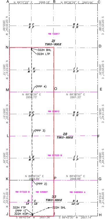
A=N: 376840.37 F: 677187.09 B=N: 376857.90 E: 679855.21 C=N: 376876.15 E: 682519.09 D=N: 374218.35 E: 682538.83 E=N: 371559.16 E: 682558.19 F=N: 368928.02 E: 682568.68 G=N: 366241.29 E: 682590.42 H=N: 364087.34 E: 682596.19 I= N: 364074.58 E: 679939.09 J=N: 364062.14 E: 677281.75 K=N: 366212.24 E: 677272.74 L=N: 368869.45 E: 677255.94 M=N: 371526.92 E: 677240.22 N=N: 374184.52 E: 677214.19 O=N: 371542.78 E: 679896.90 P=N: 366228.16 E: 679929.58
