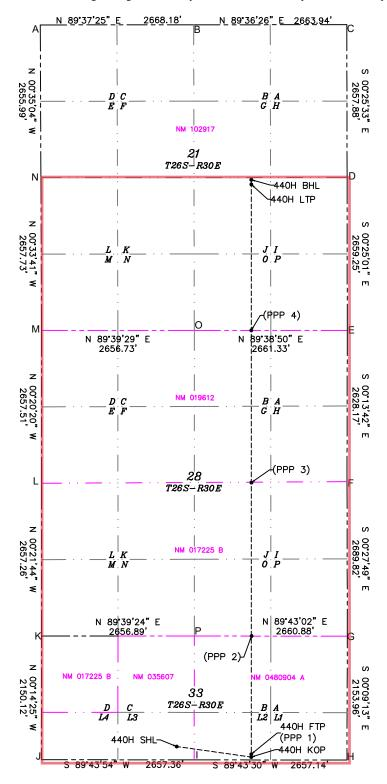
A=N: 376840.37 E: 677187.09 B=N: 376857.90 E: 679855.21 C=N: 376876.15 E: 682519.09 D=N: 374218.35 F: 682538.83 E=N: 371559.16 E: 682558.19 F=N: 368928.02 E: 682568.68 G=N: 366241.29 E: 682590.42 H=N: 364087.34 E: 682596.19 I= N: 364074.58 E: 679939.09 J=N: 364062.14 E: 677281.75 K=N: 366212.24 E: 677272.74 L=N: 368869.45 E: 677255.94 M=N: 371526.92 E: 677240.22 N=N: 374184.52 E: 677214.19 O=N: 371542.78 E: 679896.90 P=N: 366228.16 E: 679929.58
