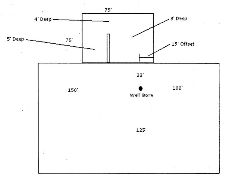
2014 BRAVO DOME DRILLING PAD
