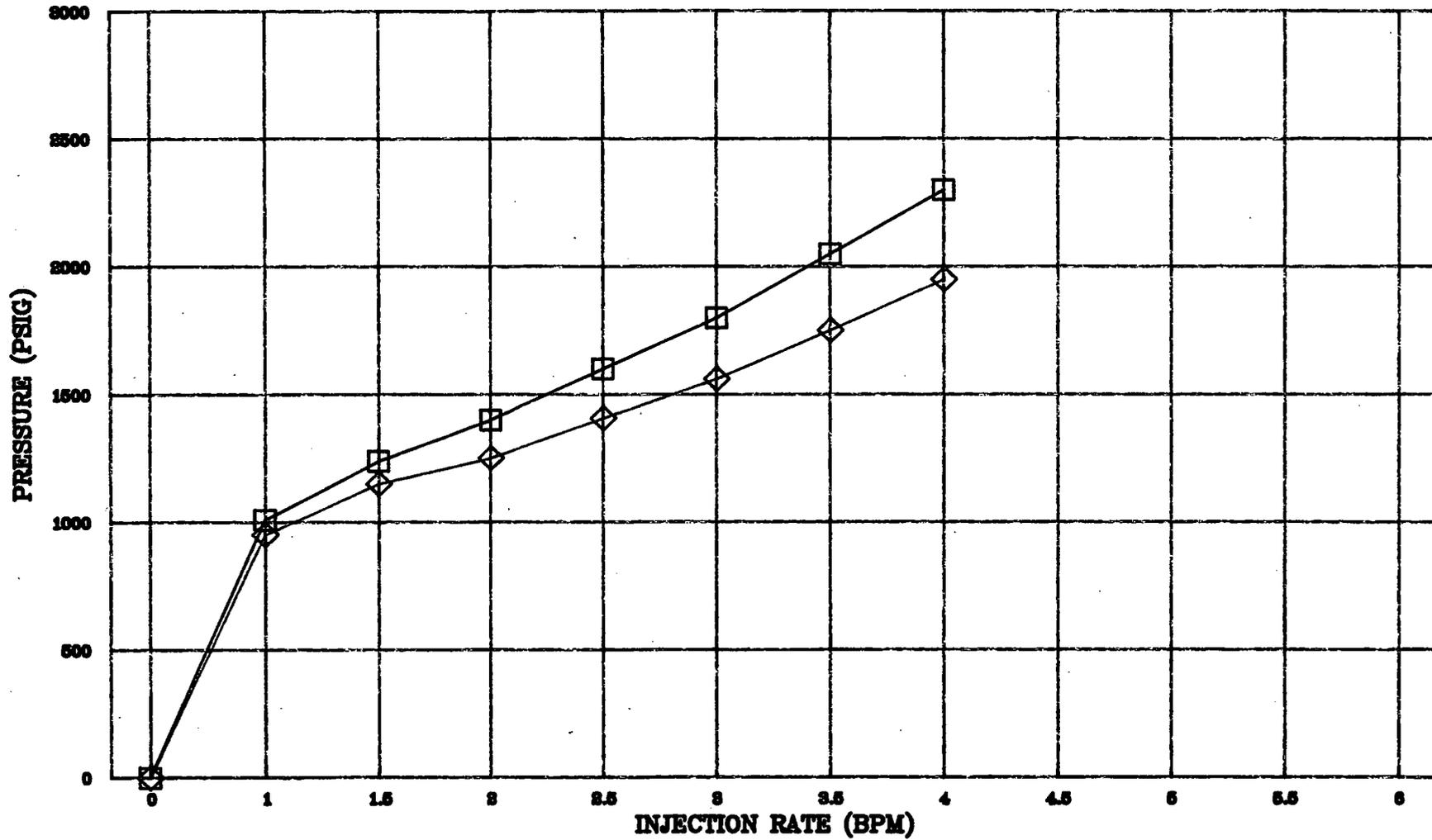
—□— SURFACE INJECTION PRESSURE      —◇— INSTANTANEOUS SHUTIN PRESSURE
