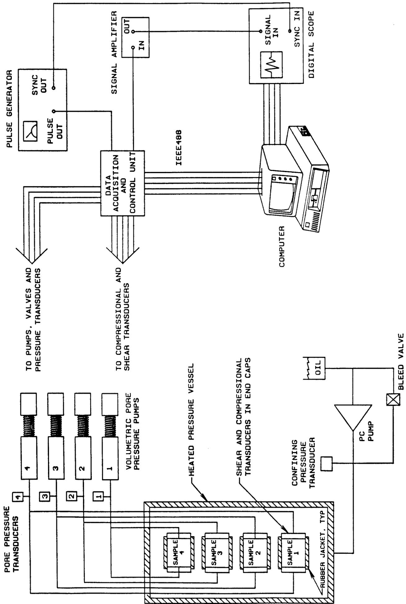
FIGURE 4: SCHEMATIC. ULTRASONIC VELOCITY SYSTEM
