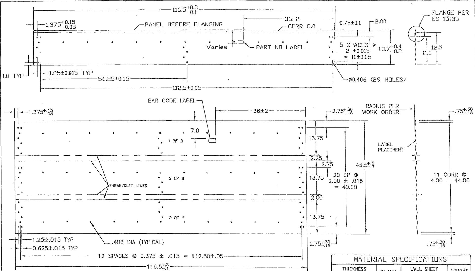
MANUFACTURING VIEW ONLY - TRIPLE PANEL AFTER CORR & PUNCH, BEFORE SLITTING & FLANGING
