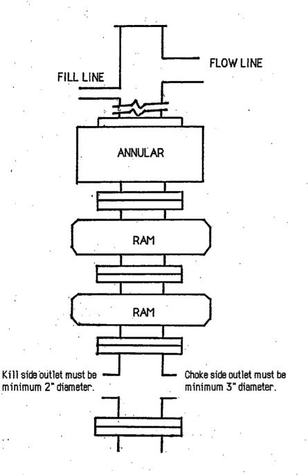
TYPICAL BOP STACK & CHOKE MANIFOLD
