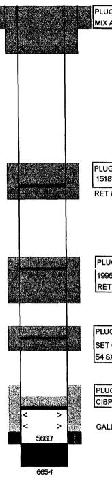
PLUG #5: 370-SURFACE. PERF @ 370'. EST CIRC MIX AND PUMP APPROXIMATELY 156 SX.
