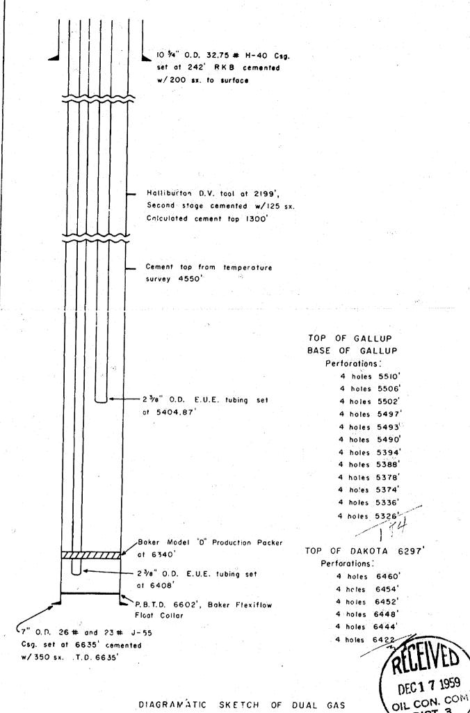
DIAGRAMÁTIC SKETCH OF DUAL GAS COMPLETION FOR WELL # 1-19
