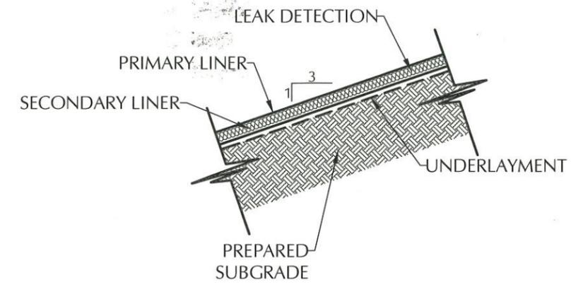
**LINER SYSTEM SIDE SLOPE DETAIL** (9)
