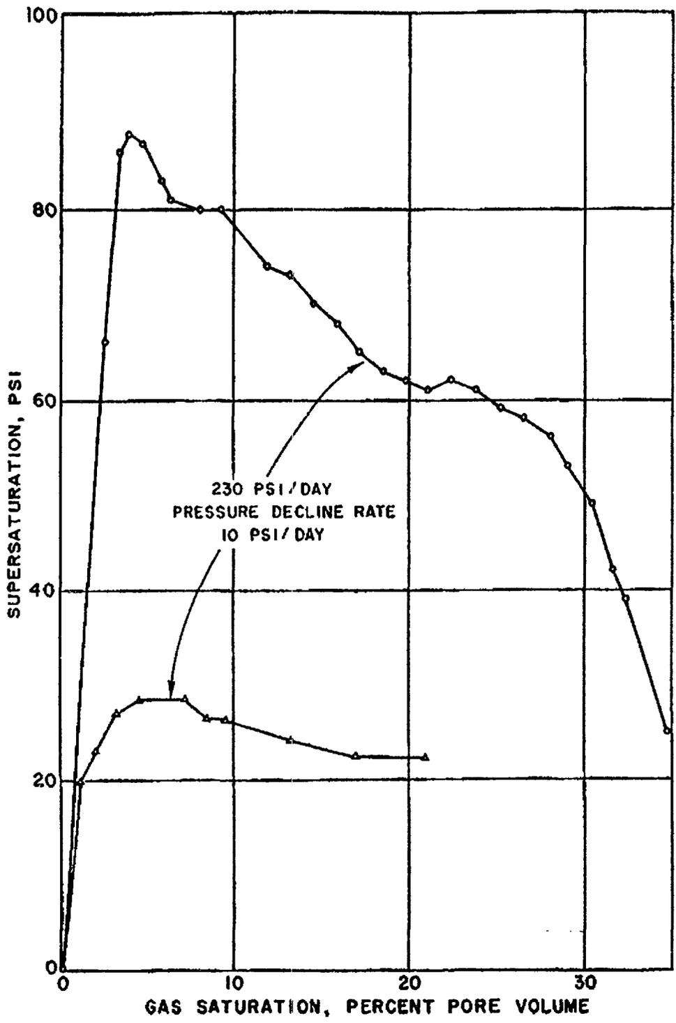
FIG. 8 - LABORATORY SUPERSATURATION PERFORMANCE OF CORDOVA SHELLSTONE.
