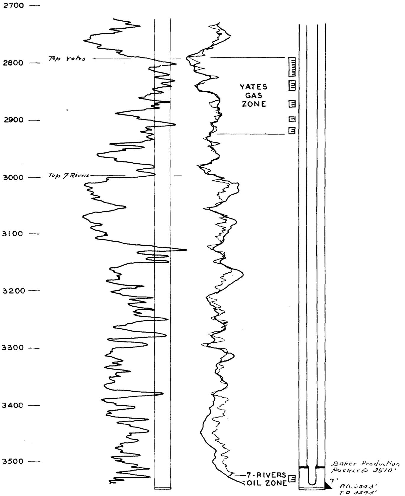
PROPOSED INSTALLATION FOR DUAL COMPLETION
