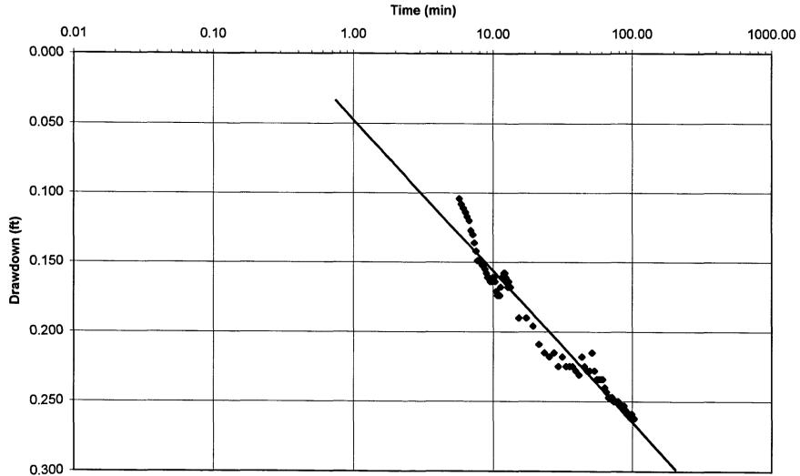
MW-5 7.0 gpm
