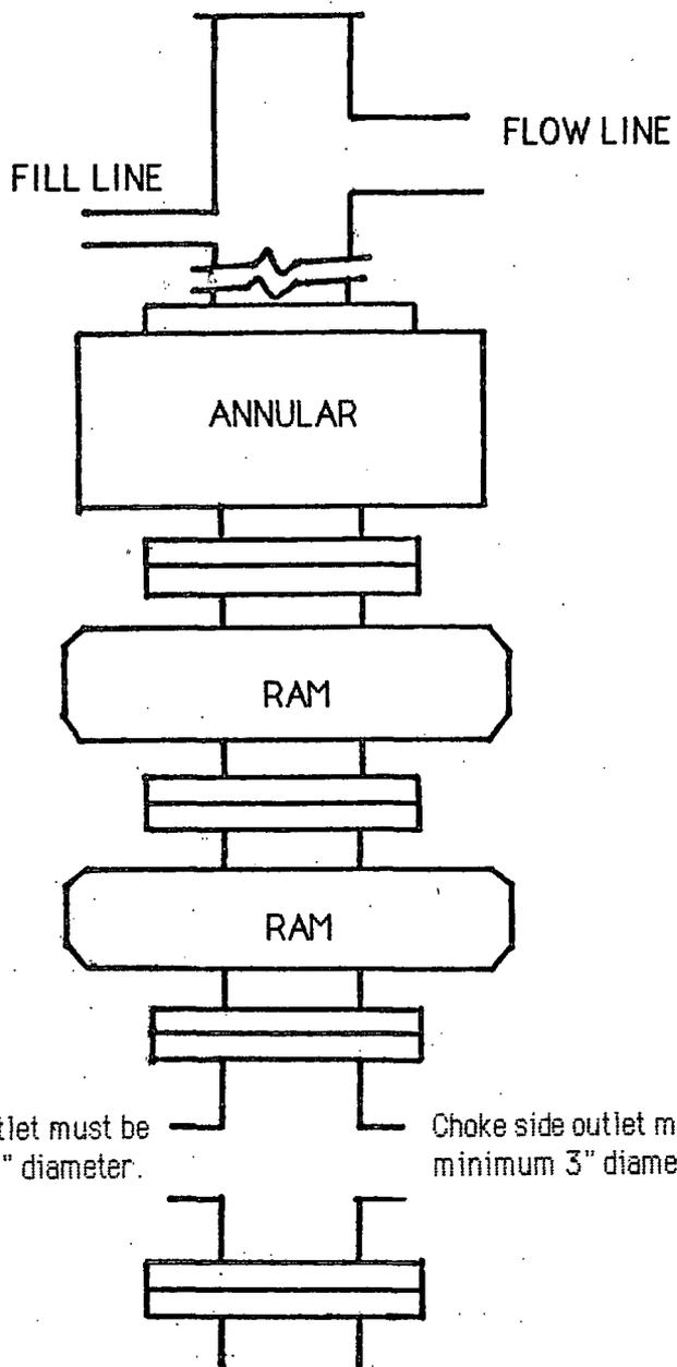
TYPICAL BOP STACK & CHOKE MANIFOLD
