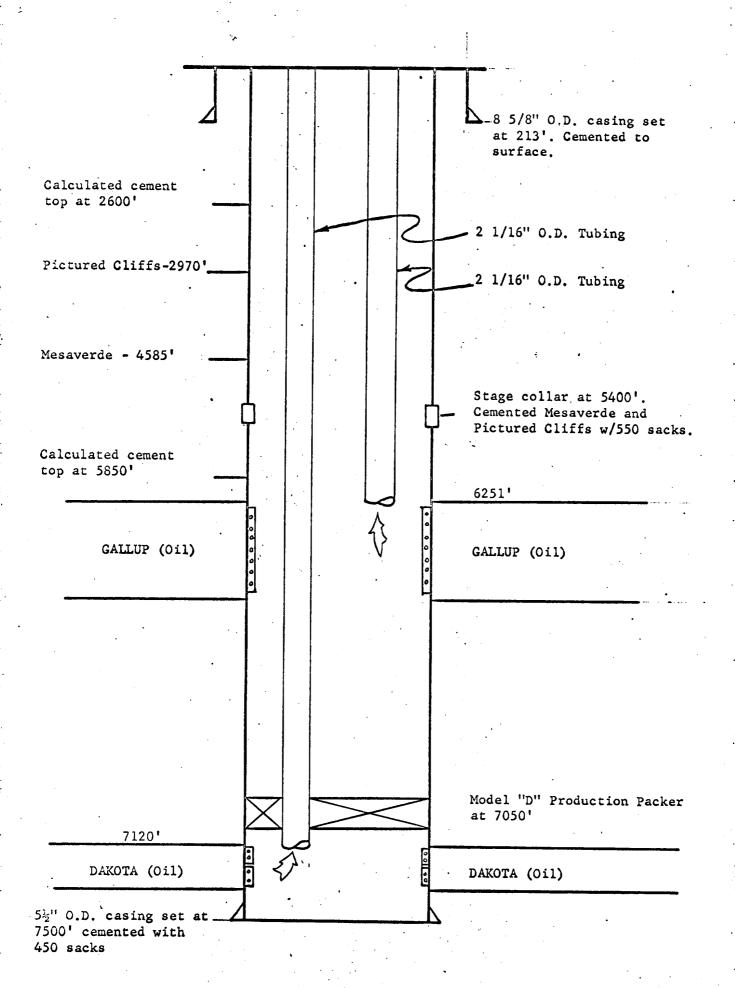
DUAL COMPLETION SCHEMATIC
