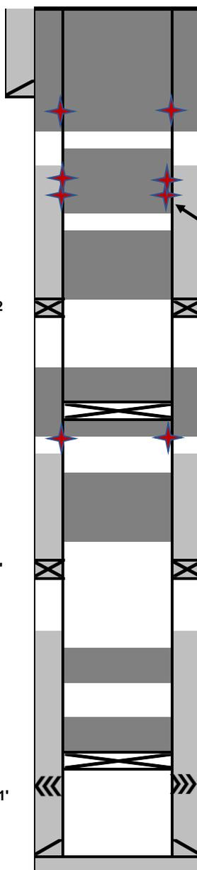
**P&A MARKER IS A 24" x 24" STEEL PLATE INSTALLED AT GROUND LEVEL**
