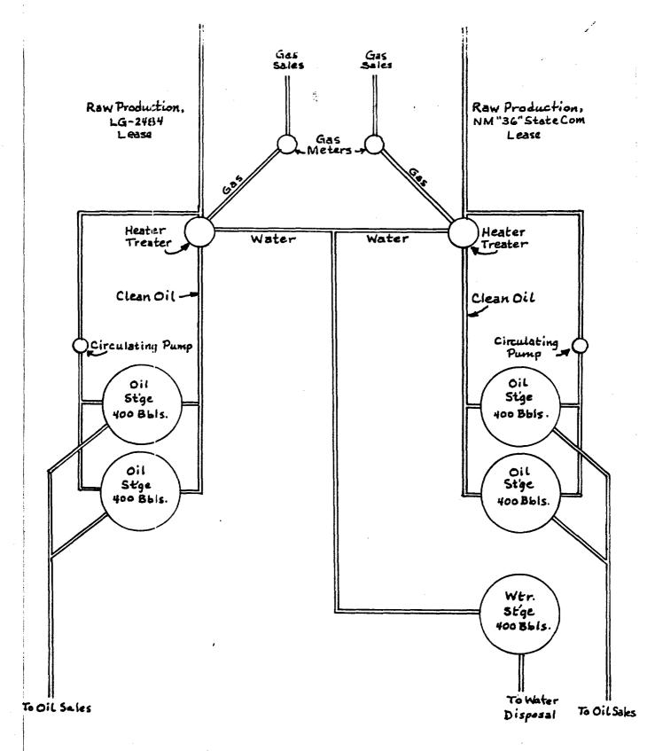
SEPARATE TANK BATTERIES
