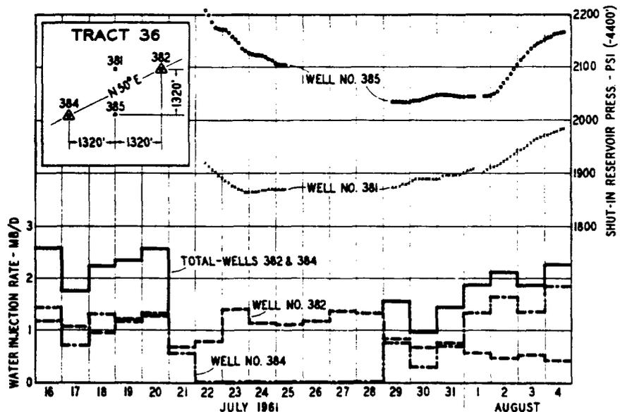
FIG. 4—UPPER SPRABERRY INTERFERENCE TEST, SPRABERRY DRIVER UNIT.
