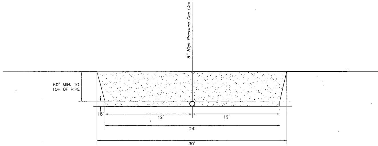
BACKFILL DIRT TO BE AS FREE OF ROCKS AND
