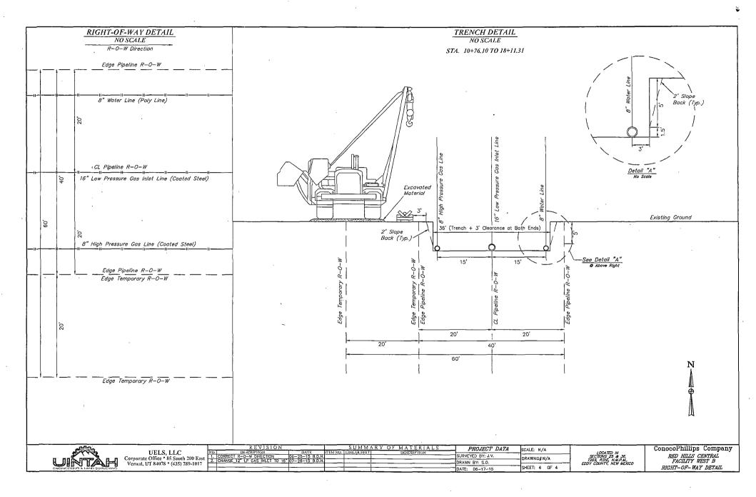
BACKFILL DIAGRAM NO SCALE
