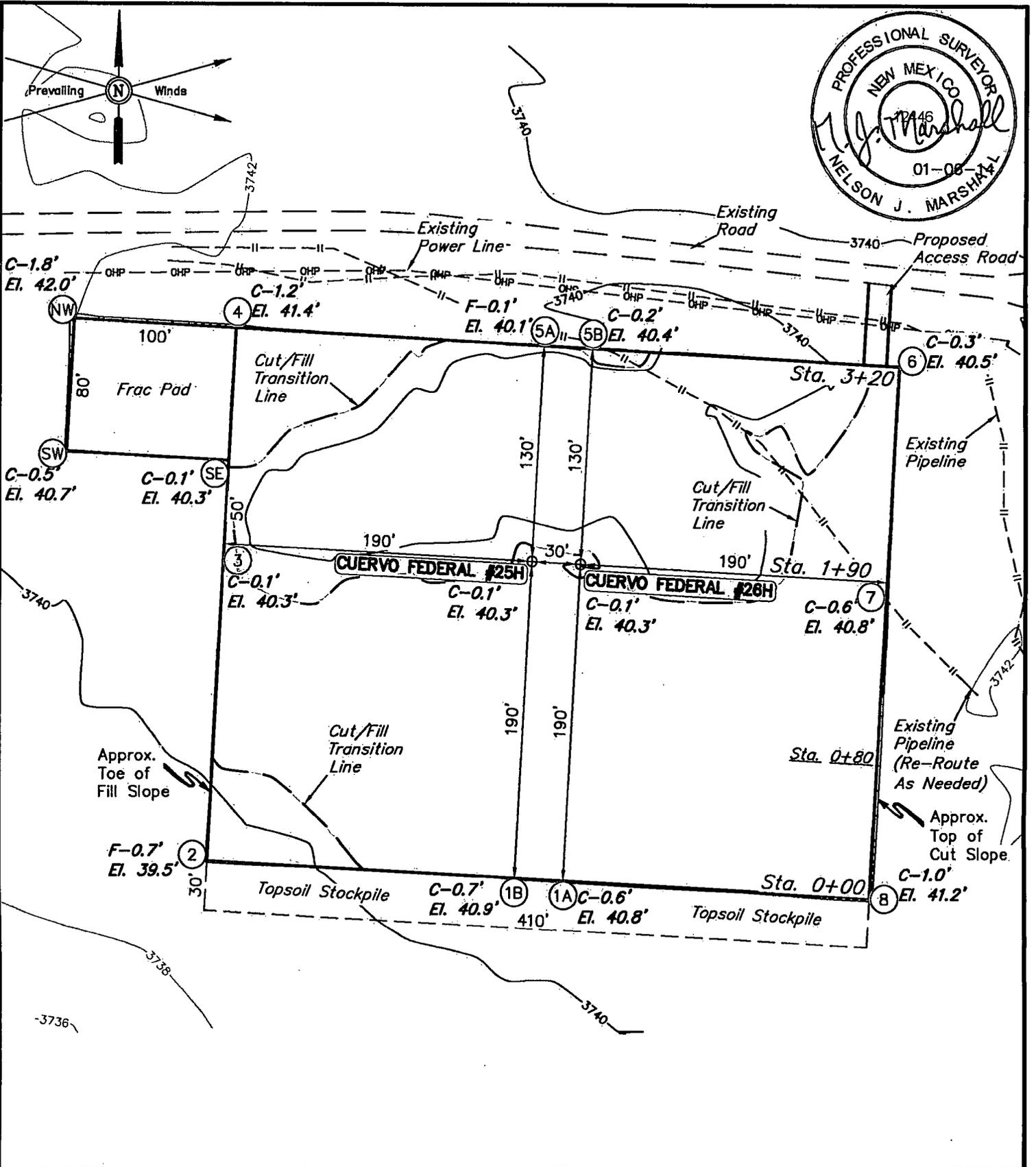
ELEV. UNGRADED GROUND AT #25H LOC. STAKE = 3740.3' FINISHED GRADE ELEV. AT #25H LOC. STAKE = 3740.2'
