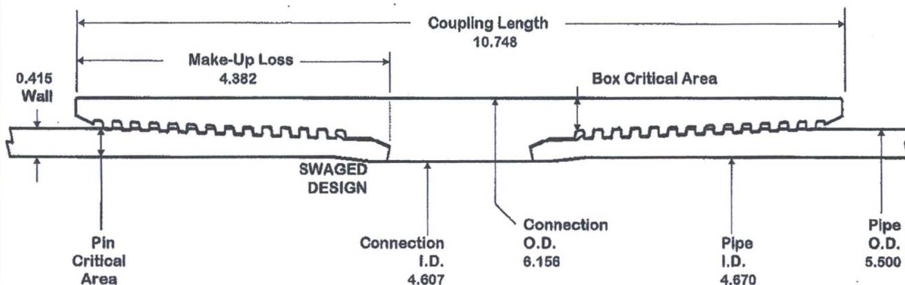
O.D. 5.500      WEIGHT 23.00      WALL 0.415      GRADE NSSMCP110HC      DRIFT 4.545
