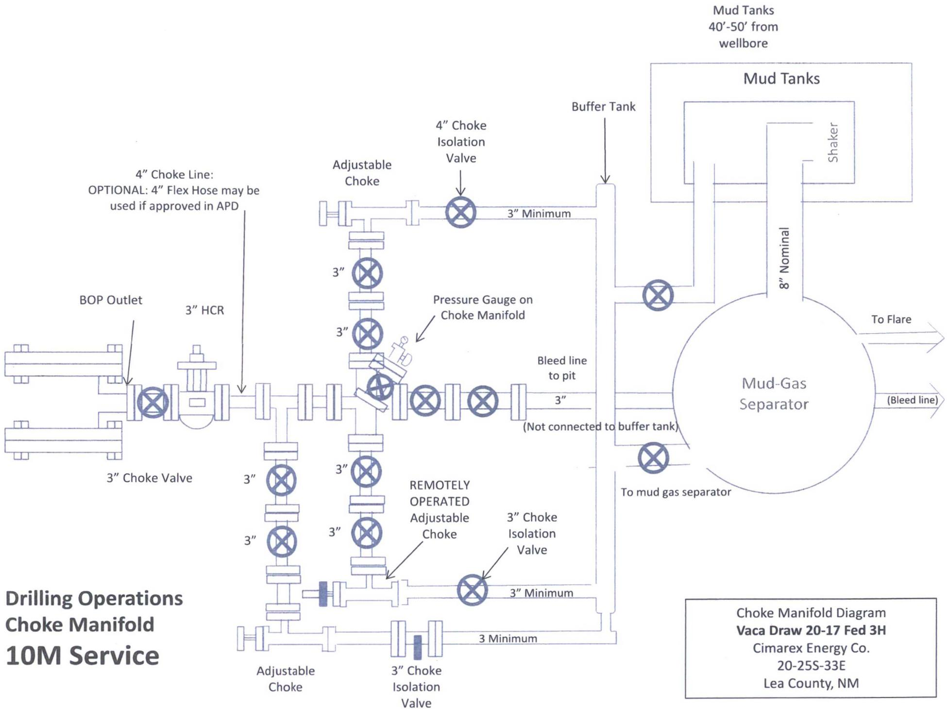
**Choke Manifold Diagram
