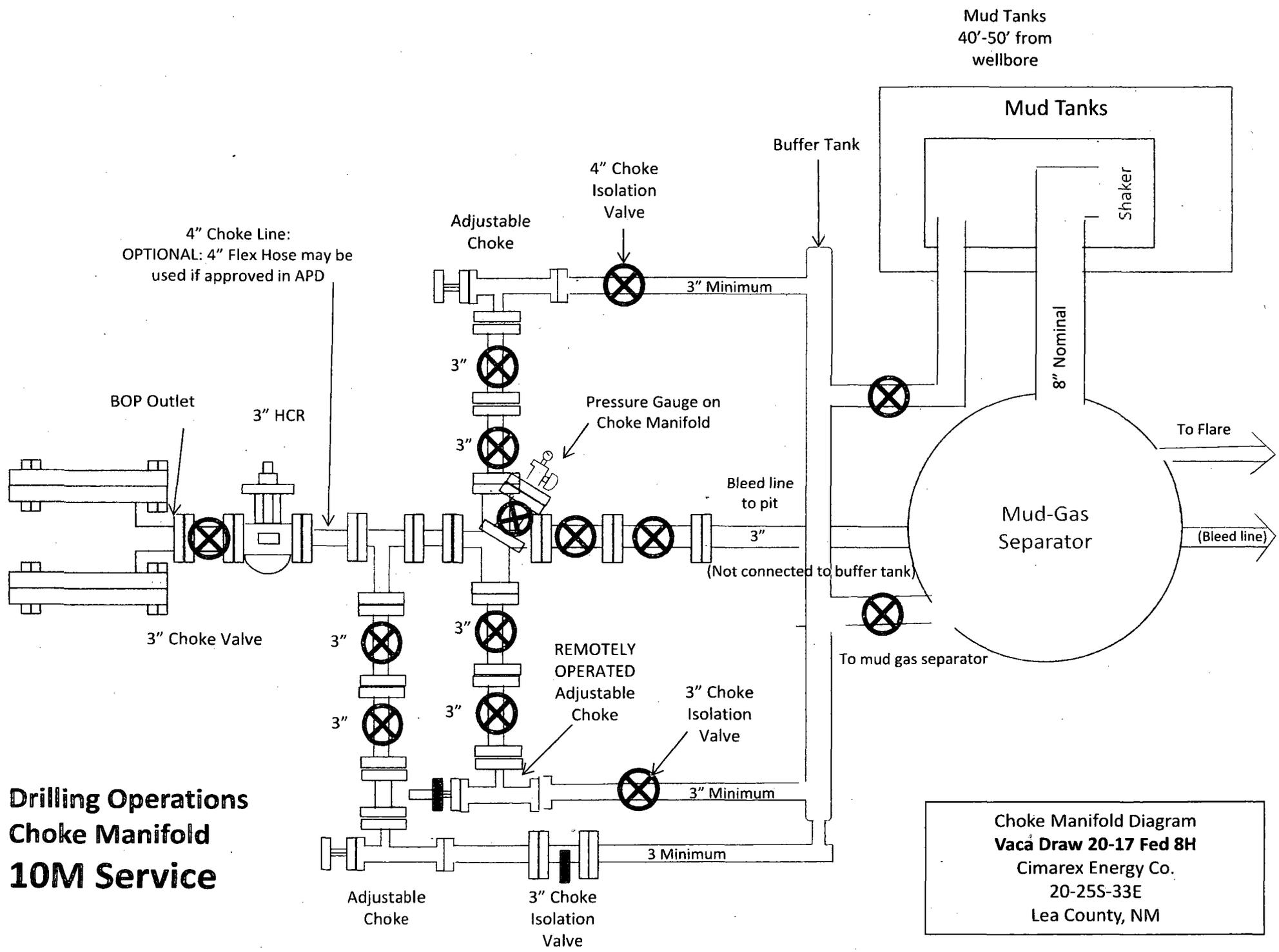
**Choke Manifold Diagram
