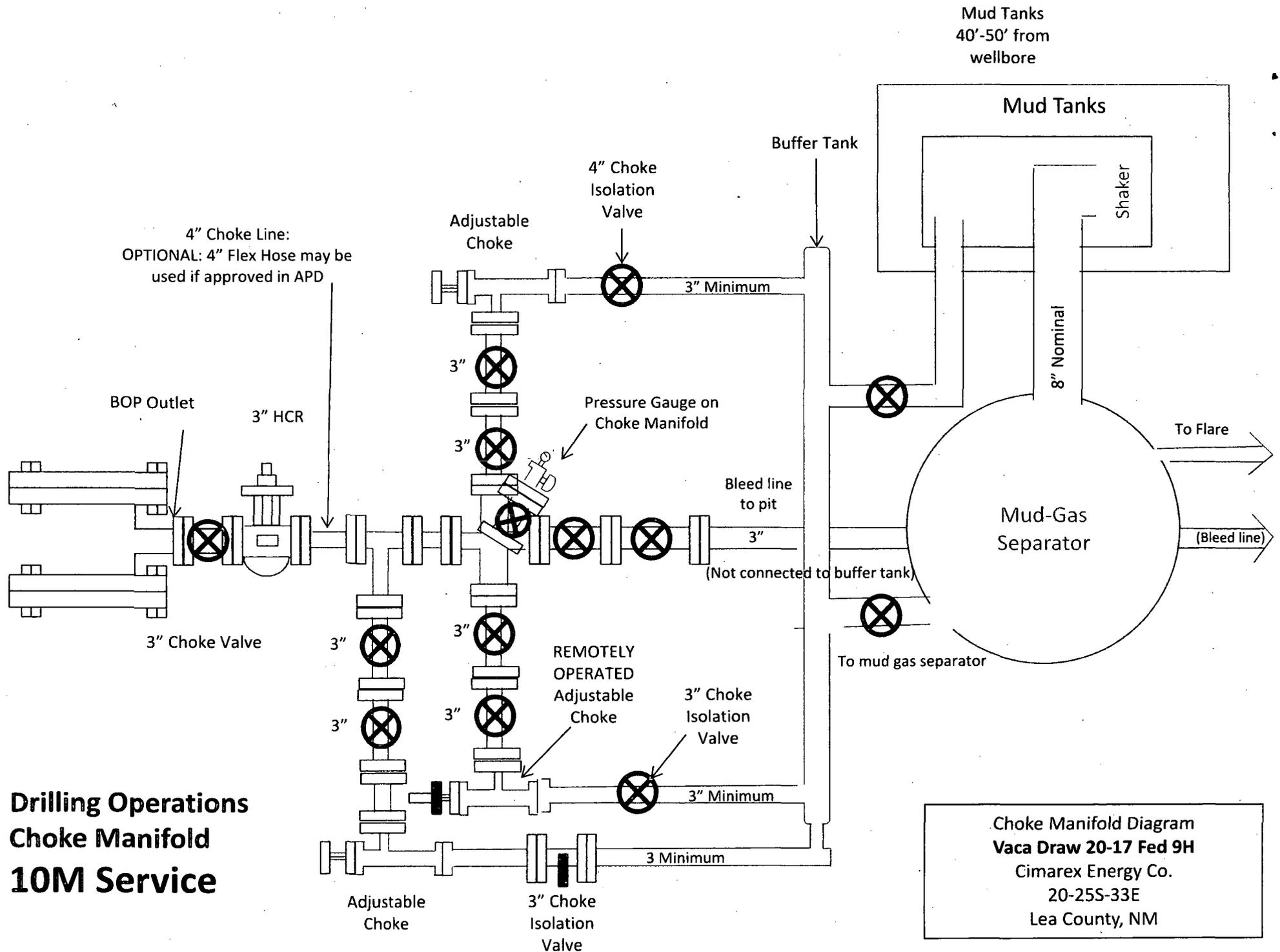
**Choke Manifold Diagram
