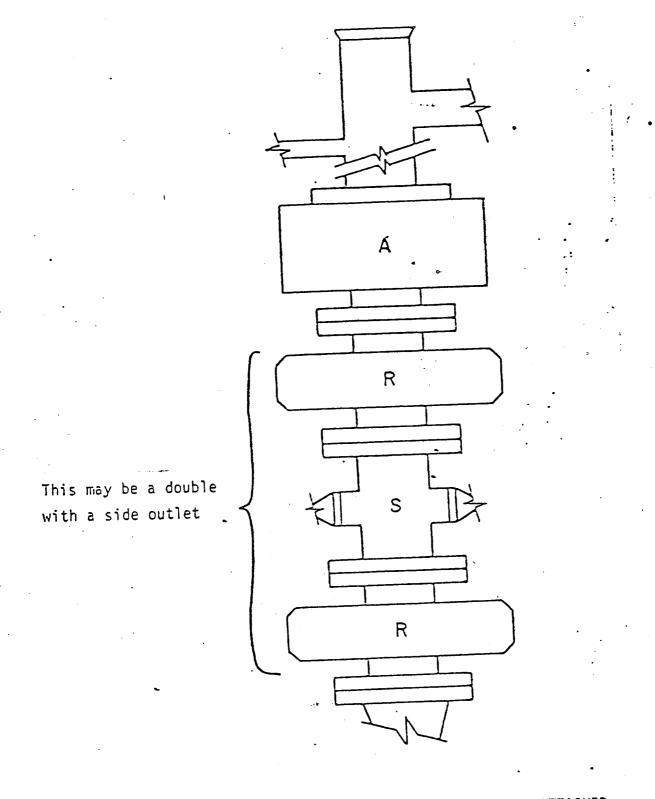
NOTE: IT IS RECOMMENDED THAT THE CHOKE LINE BE ATTACHED ABOVE THE BOTTOM PREVENTER
