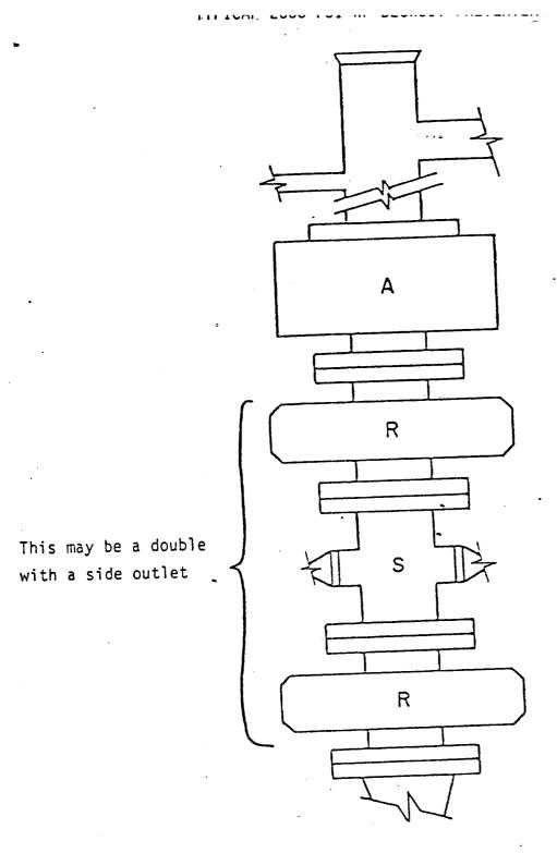
NOTE: IT IS RECOMMENDED THAT THE CHOKE LINE BE ATTACHED ABOVE THE BOTTOM PREVENTER
