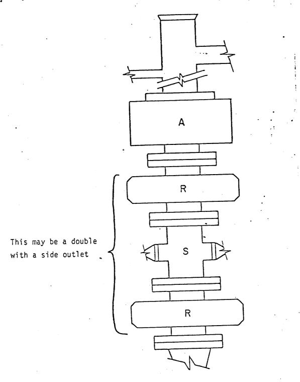
NOTE: IT IS RECOMMENDED THAT THE CHOKE LINE BE ATTACHED ABOVE THE BOTTOM PREVENTER
