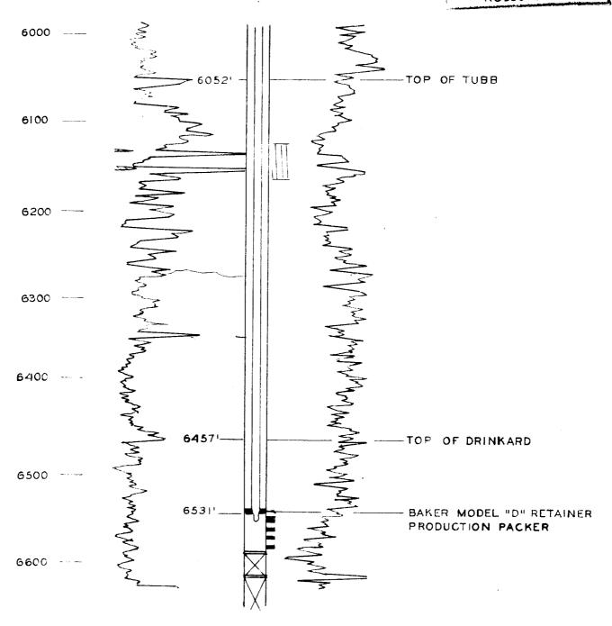
PROPOSED INSTALLATION FOR DUAL COMPLETION
